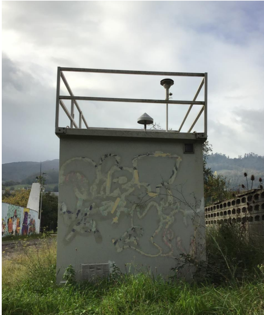
Figura 107. Toma de muestra de gases y partículas y estación meteorológica de la estación Blimea
