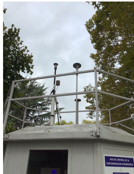
Figura 54. Toma de muestra de gases y partículas y estación meteorológica de la estación Sama I
