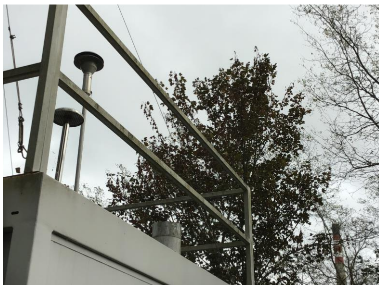
Figura 38. Toma de muestra de gases y partículas de la estación Meriñán
