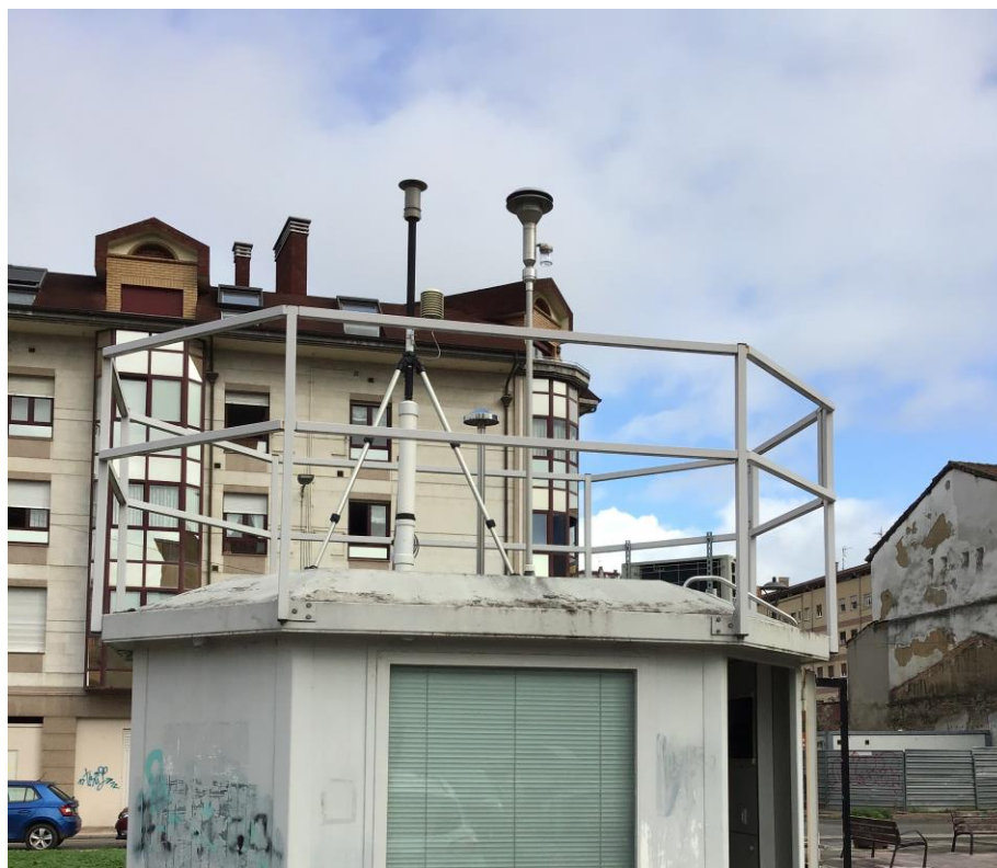
Figura 72. Toma de muestra de gases y partículas y estación meteorológica de la estación La Felguera
