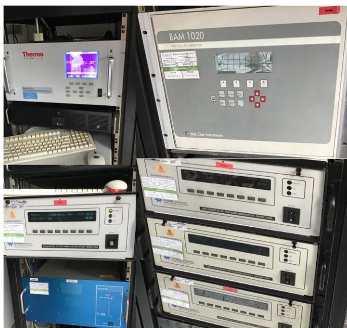
Figura 42. Equipos de medida de la calidad del Aire de la estación Sama I
